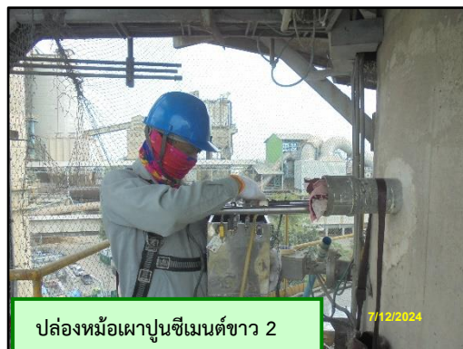
ภาพที่ 3.3 การตรวจวัด NO x as NO 2 จากปล่องหม้อเผาปูนซีเมนต์ขาว 1 และ 2
