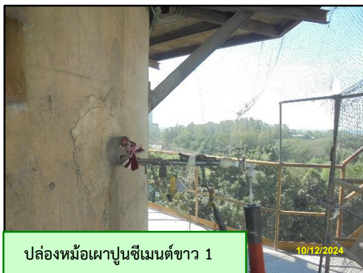
ภาพที่ 3.2 การตรวจวัด TSP และ SO 2 จากปล่องหม้อเผาปูนซีเมนต์ขาว 1 และ 2
