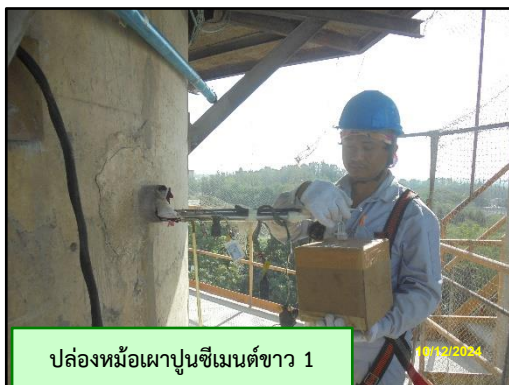
ภาพที่ 3.3 การตรวจวัด NO x as NO 2 จากปล่องหม้อเผาปูนซีเมนต์ขาว 1 และ 2
