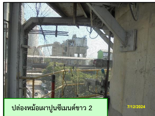
ภาพที่ 3.2 การตรวจวัด TSP และ SO 2 จากปล่องหม้อเผาปูนซีเมนต์ขาว 1 และ 2
